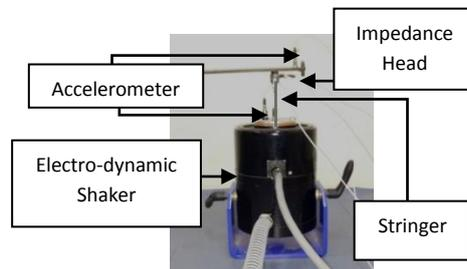
Fig. 8. STRINGER ATTACHMENT TO BEAM
